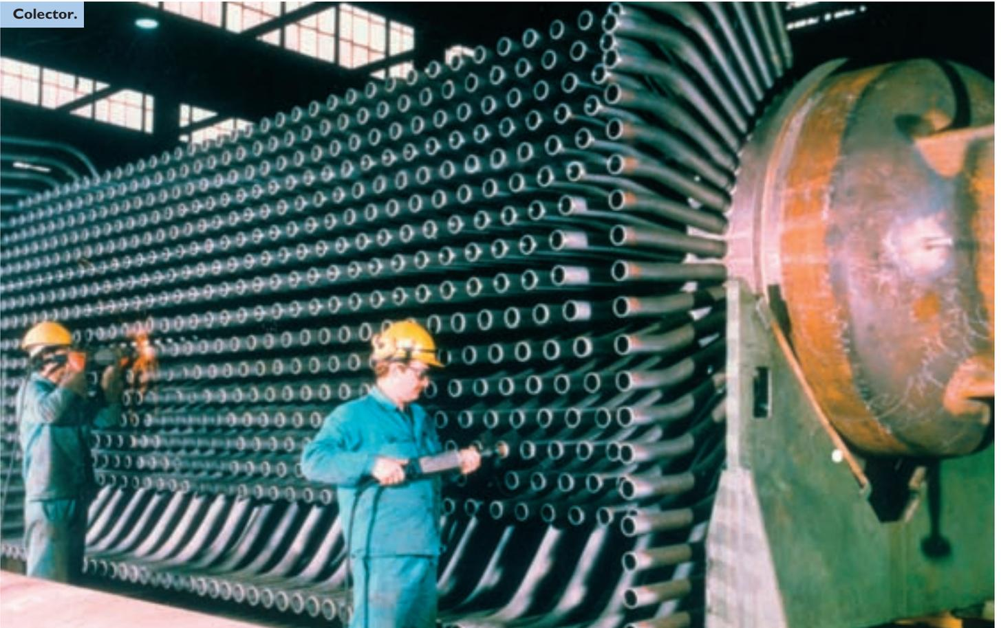
Tubo hacia las soldaduras de unión del colector de una caldera de recuperación del calor residual.
